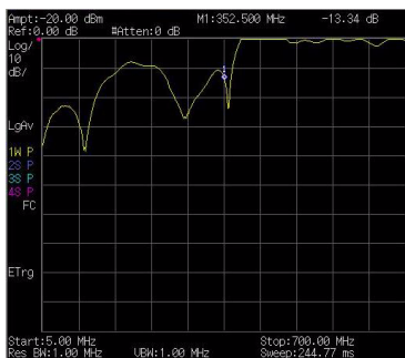
图 21 测量滤波器的回波损耗
